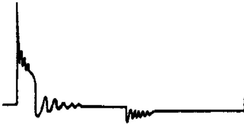
Рис 4.2.19 Указывает на высокое сопротивление свечного колпачка (наклон вниз линия горения искры и высоко расположенная линия зажигания искры).
